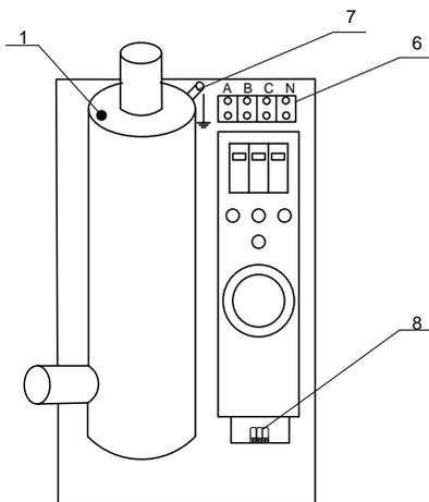
3.2. Водонагреватель электрический «Star Control» состоит из водонагревателя 1, корпуса 2, защитного автоматического выключателя включения водонагревателя 3, контроллера 4, колодки подключения датчиков температуры и циркуляционного насоса 5, колодки подключения электропитания котла 6 и клеммы заземления 7. Внешний вид котла представлен на рис 2.
