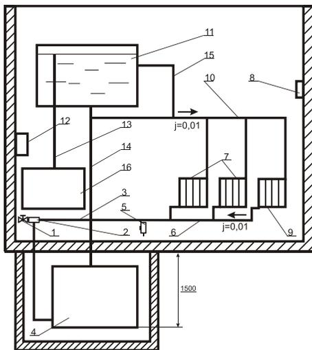
1 – вентиль; 2 – тройник; 3 – магистраль; 4 – электронагреватель воды; 5 – вентиль для спуска воды; 6 – обратная магистраль; 7, 9 – батарея отопления; 8 – термодатчик; 10 – подающая магистраль; 11 – расширительный бак; 13 – соединительная труба; 14 – главный стояк; 15 – сливной патрубок; 16 – раковина.
